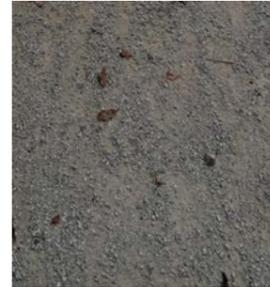
Afin de garantir une atmosphère sèche, propice à une bonne conservation des livres, nous proposons de mettre une couche d'isolant pour l'humidité au sol (toile PVC) et recouvrir cette toile de stabilizer argilo calcaire du Salève. Cette installation ne nécessite pas un travail important et garanti peu d'entretien. Cette matière argilo-calcaire est un matériau fabriqué à base de stérile de carrière.
